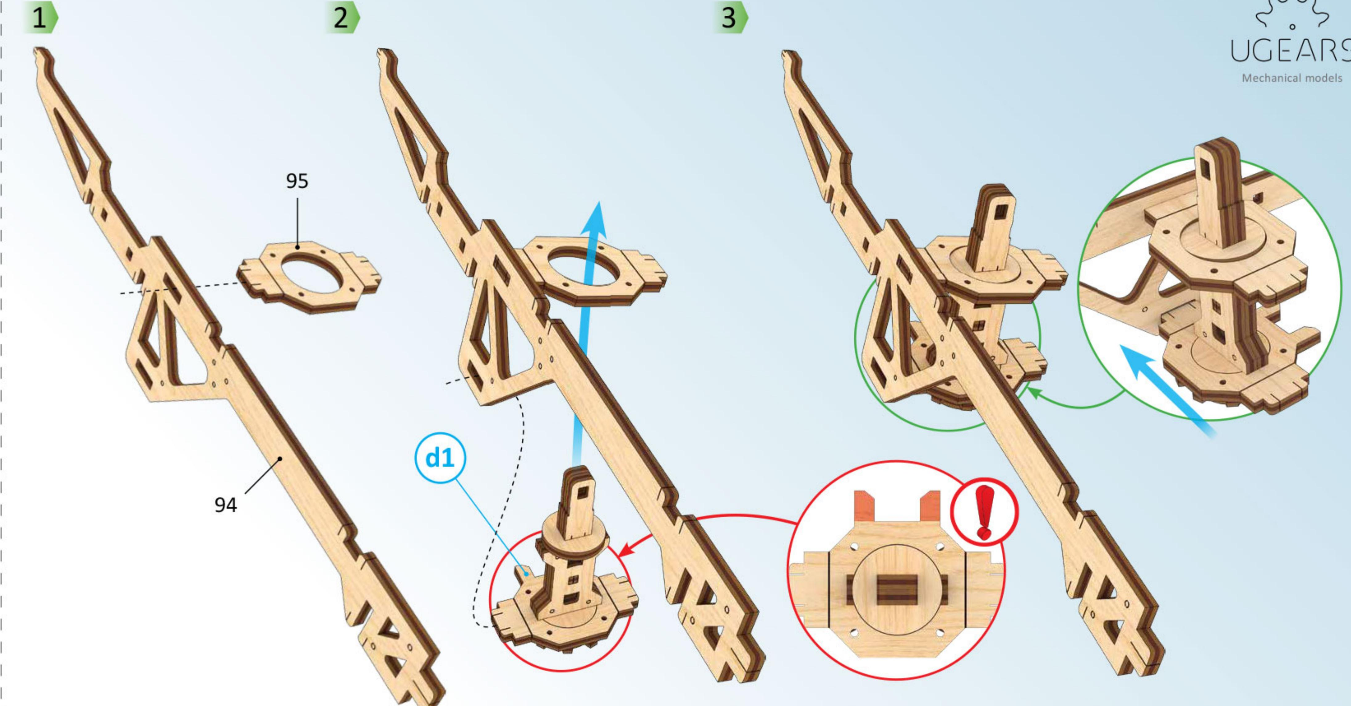
ENG Check the mechanism for smoothness and accuracy of movement. Operate the mechanism so the parts would seat-in. UKR Перевірте механізм на плавність і точність ходу. Розробіть механізм.
